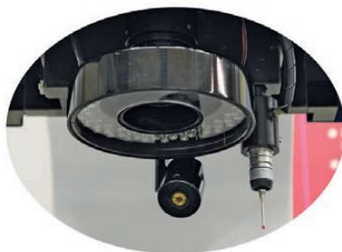
Gruppo ottico con puntatore laser e tastatore
