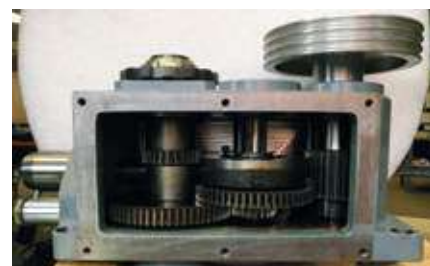
Scatola ingranaggi in bagno d'olio.
